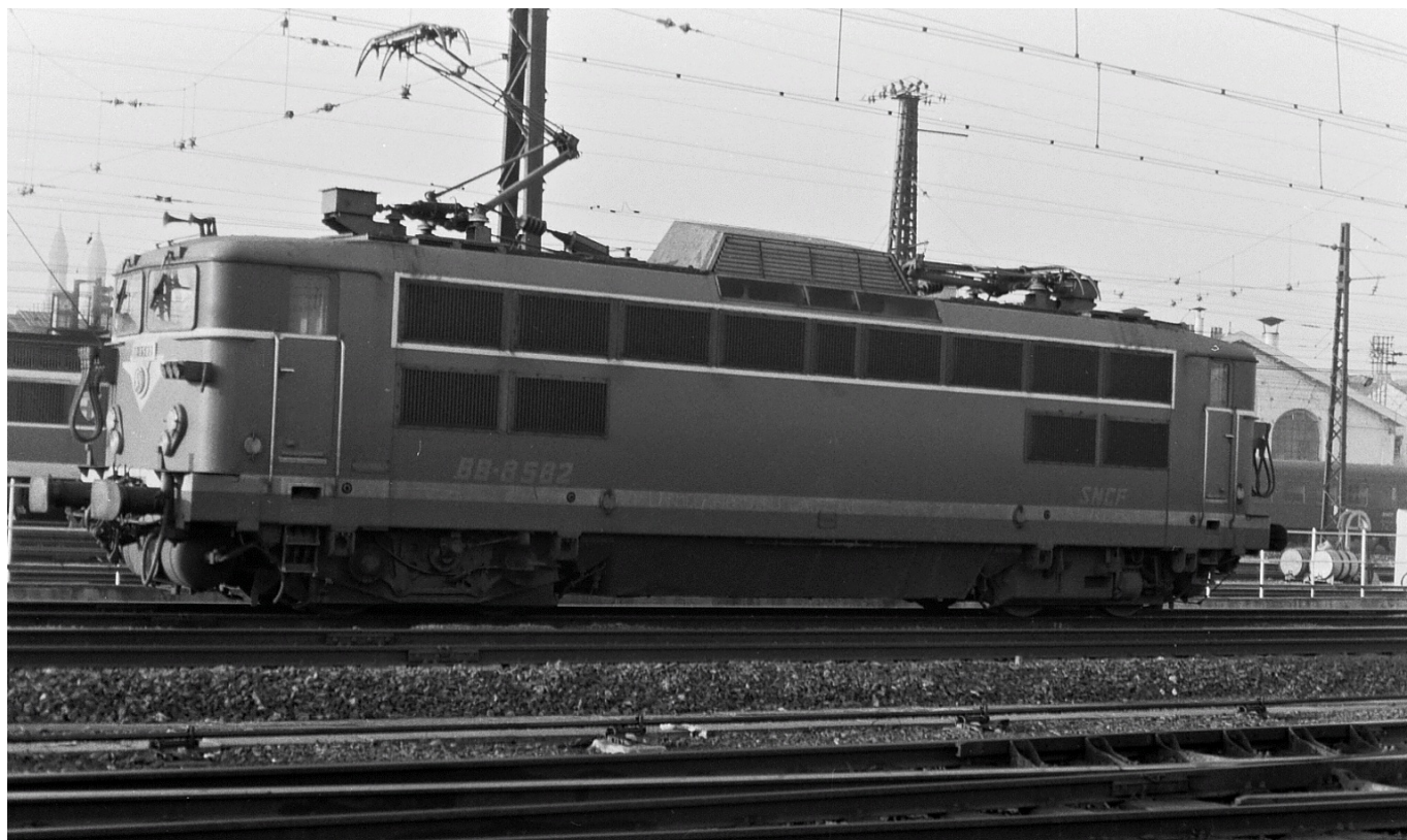
BB 8582 caisse courte de 14,940 m à traversses renforcées, livrée d'origine sigle Beffara
