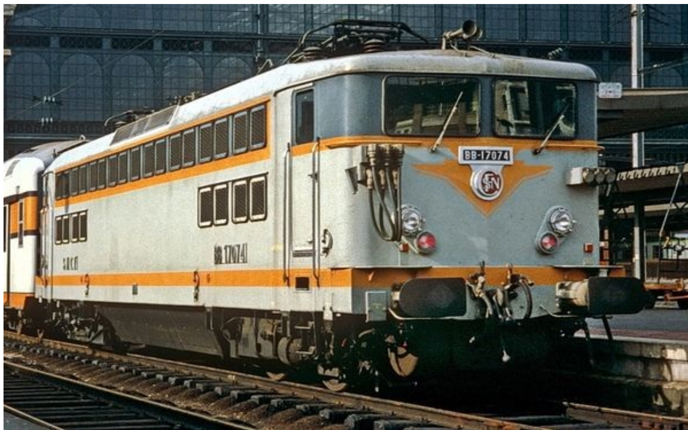
BB 17074 livrée Béton caisse courte de 14,950 m à traverses de tête renforcées, plaquée
