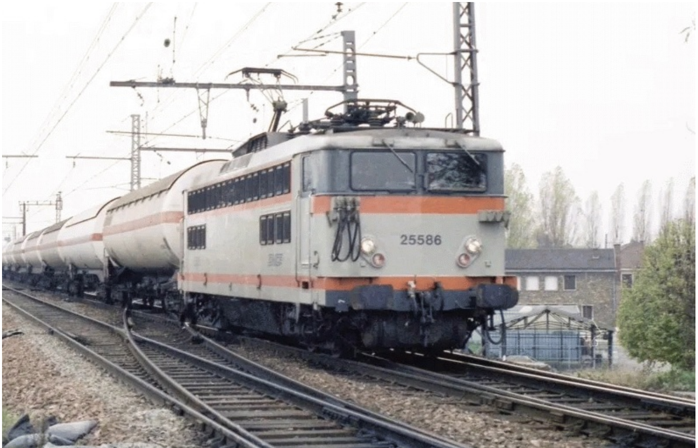
BB 25586 caisse courte de 14,950 à traverses renforcées livrée Béton logo Tallon
