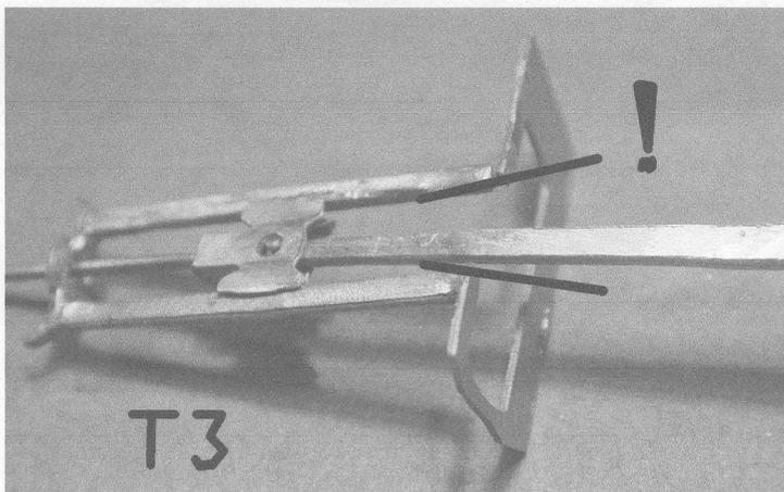
Gleitbahnträger bei Bedarf freischleifen
